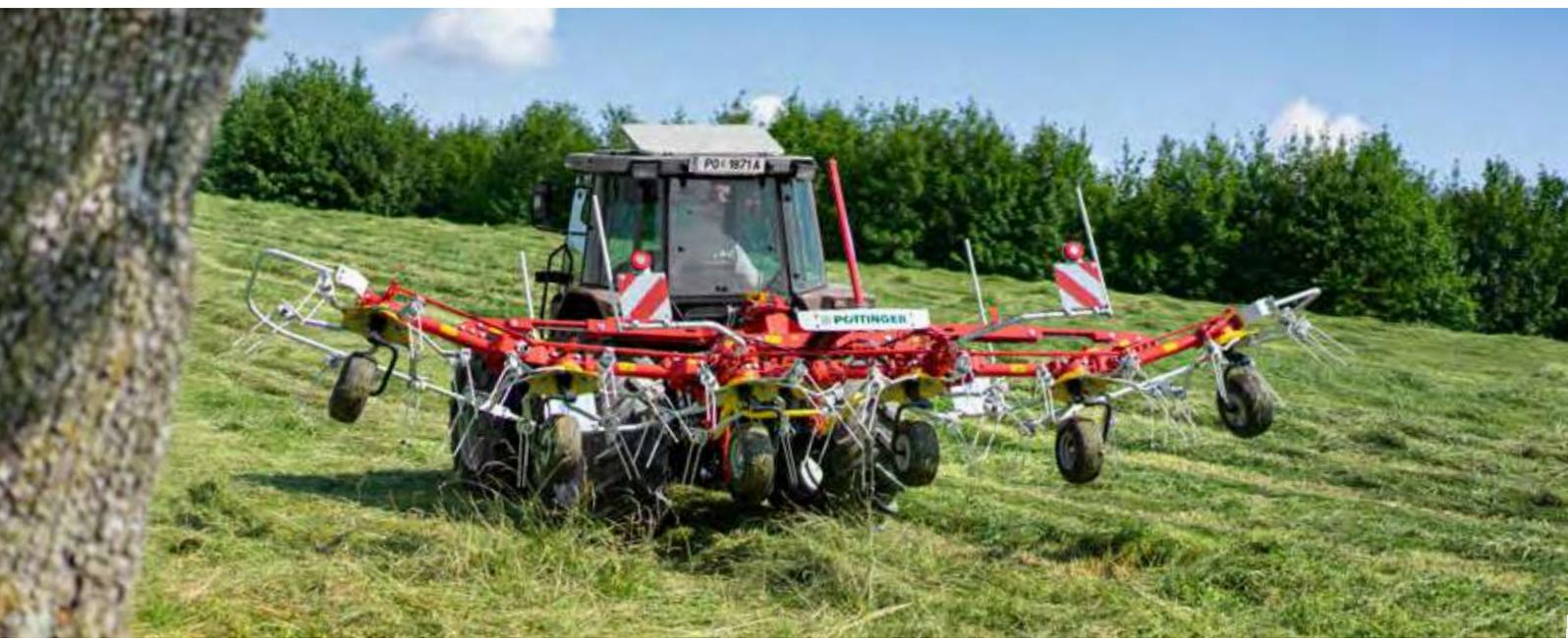
A fine campo sussiste il pericolo elevato che a macchina sollevata i giranti esterni raschino il terreno danneggiando la cotica erbosa. Perciò PÖTTINGER, in base alle necessità ed all'altezza di sollevamento del trattore, offre per ogni modello sistemi perfettamente coordinati per consentire una sufficiente libertà dal suolo. La cotica erbosa viene protetta ed il vostro foraggio resta pulito.
